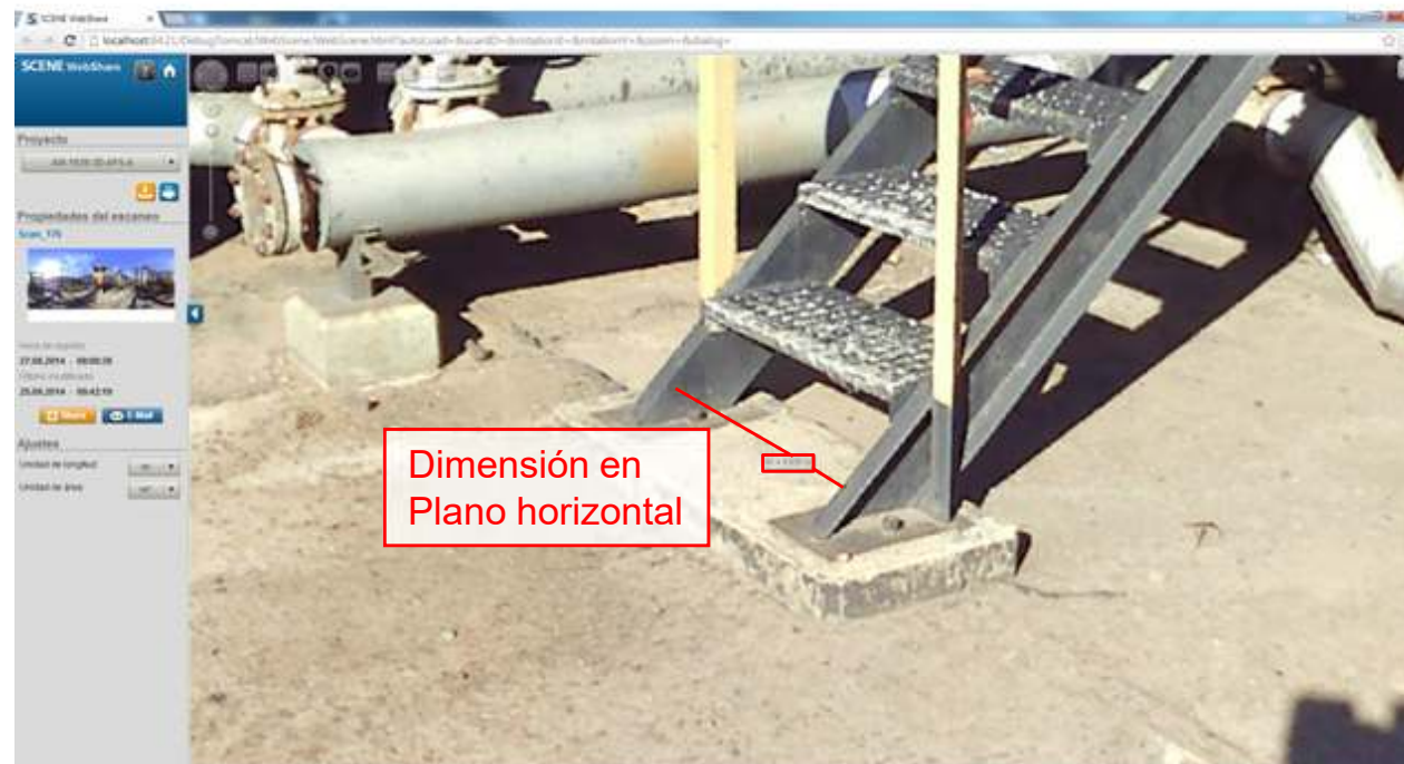
EJEMPLO MEDICIÓN DE DOS PUNTOS EN EL PLANO HORIZONTAL
