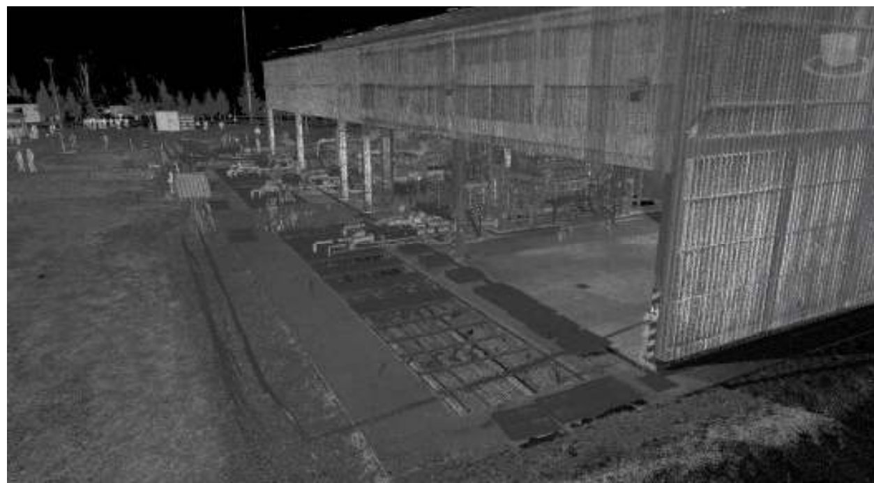
MODELO DIGITAL TRIDIMENSIONAL GENERADO CON SCANNER LASER 3D
